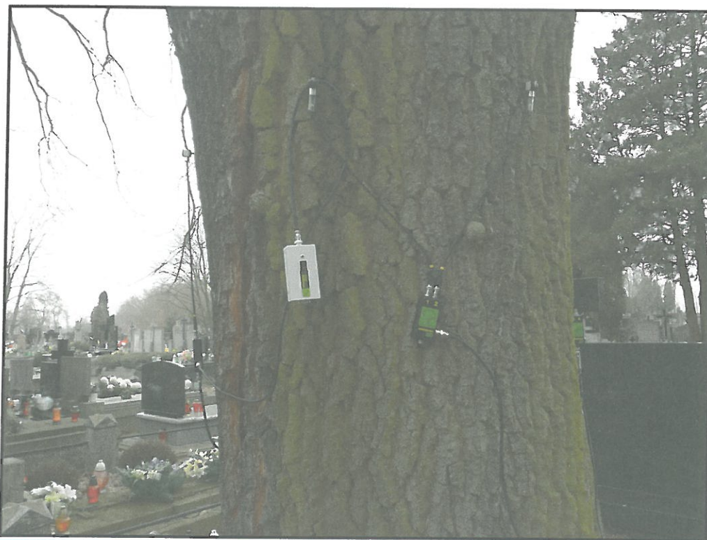
Fot. 4 Badanie tomografem akustycznym wykazało, iż pień drzewa jest w dobrym stanie zachowania (fot. T. Łyszcz)
