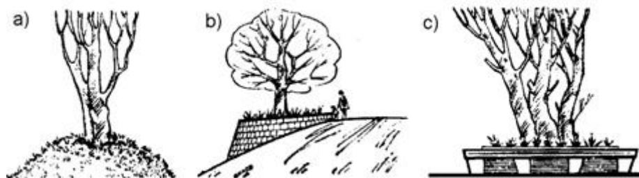
a) pozostawiony ścięty stożek z gruntu, ochraniający korzenie drzewa b) ścianka podporowa z kamienia wokół drzewa pozostawionego na skarpie c) ścianka oporowa dostosowana do odpoczynku podróżnych przez wykonanie ławki na jej górnej powierzchni
